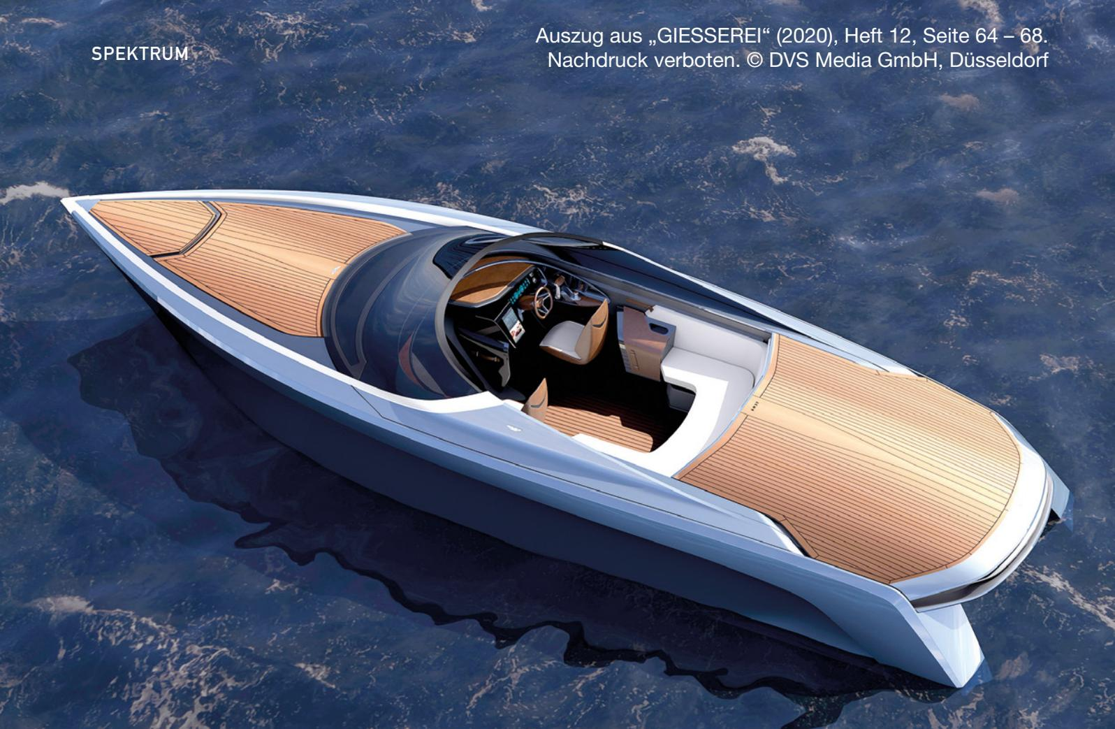
Gedruckte Rahmenkonstruktion für die Windschutzscheibe eines High-Speed-Bootes.
